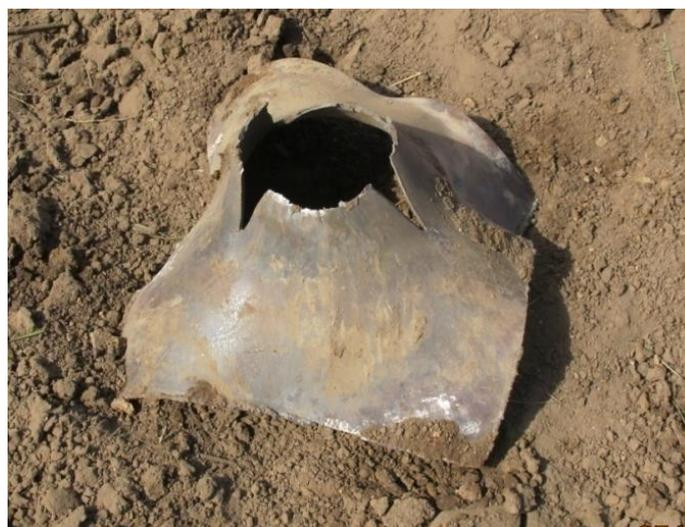
Рисунок 30 - Вид плиты-свидетеля со стороны, обратной расположению заряда, после опыта (сквозное пробитие плиты с выбросом "пятак" в грунт и разрывом кромок отверстия - детонация испытуемого заряда "полная")
