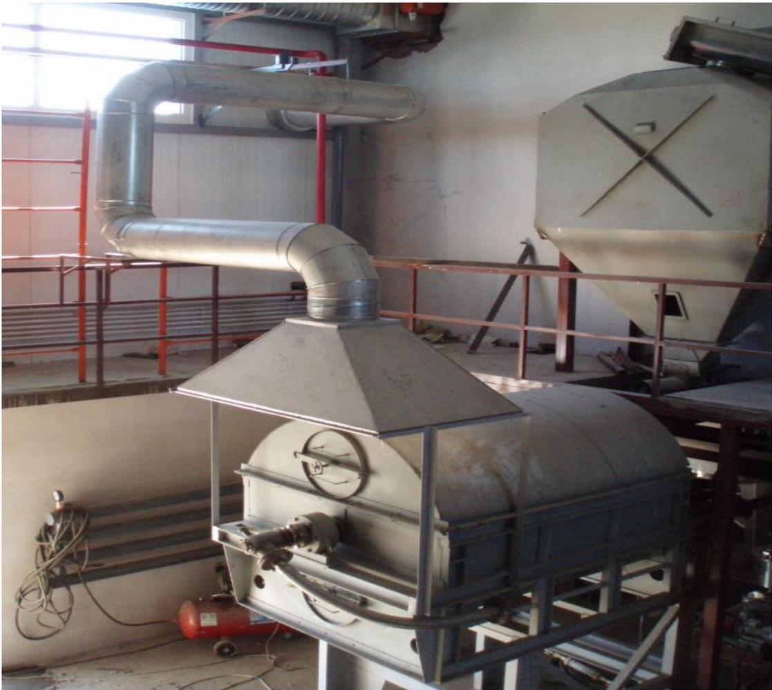
Рисунок 11а – барабанный аппарат нагрева АС с бункером питателем (на фото - справа вверху) и системой вентиляции с зонтом над зоной выгрузки
