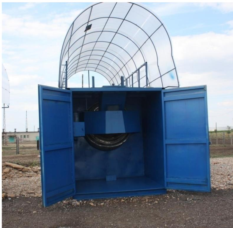
Рисунок 10 – модуль смесительного барабана комплекса МППСВВ
