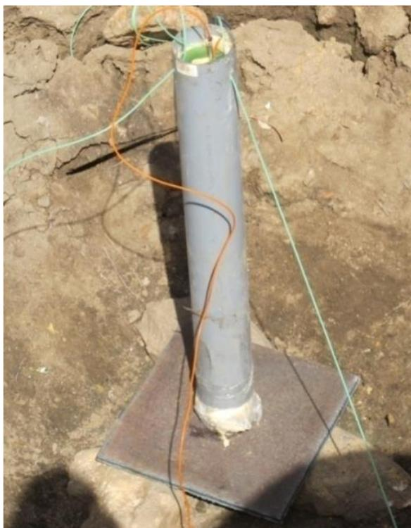
Рисунок 29 - Внешний вид заряда (фото) в оболочке из ПВХ трубы диаметром 100 мм (заряд, для уменьшения интенсивности ударной волны, установлен в воронке в грунте от предыдущего опыта)
