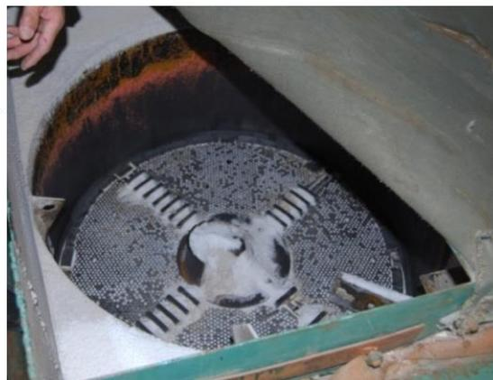
Рисунок 4- Измельчитель-смеситель игданита (ИСИИ-П) разработки производственного объединения «Северовостокзолото» (г. Магадан) с рыхлительно-сепарирующим органом в виде горизонтального вращающегося диска (тарели) с отверстиями (на фото справа)
