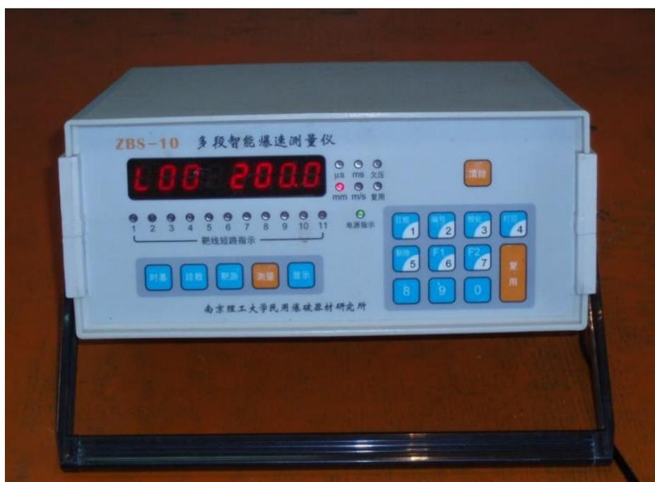
Рисунок 27 - Измеритель интервалов времени многоканальный с функцией контроля целостности измерительных цепей (прибор типа ZBS – 10).
