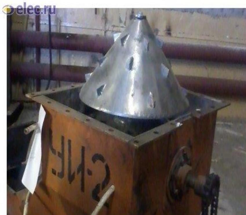
Рисунок 5б – Установка изготовления ВВ типа АСДТ (УИ-2) разработки Казахского политехнического института (правопреемник – НПП «ИНТЕРРИН») с измельчающим органом в виде конуса ( конус показан извлеченным из корпуса).
